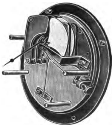
Abb. 448. Statisches Voltmeter der Allgemeinen Elektrizitäts-Gesellschaft.
